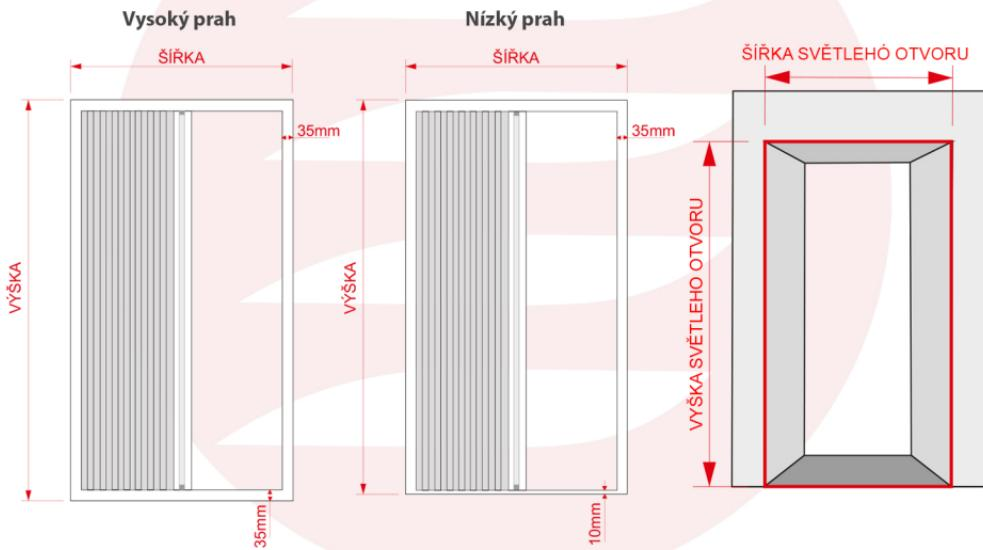
Objednací šířka = Zaměřena šířka od ostění po ostění - 2mm.
