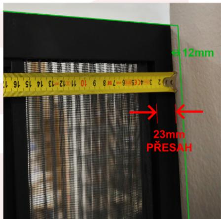
**Objednací rozměr je koncový (obrysový) rozměr celého výrobku.**
